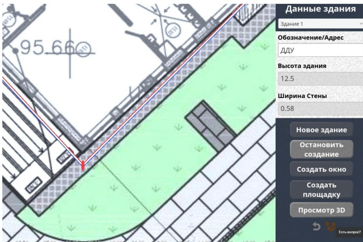
Рисунок 5.14: Смещение расположения углов здания при обводке
