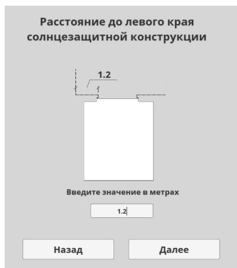
Рисунок 5.37: Расстояние до края солнцезащитной конструкции (козырька)
